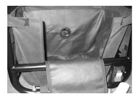
На задней стороне мешка расположен патрубок пылеудаления. Внутренний диаметр патрубка 57 мм, а наружный диаметр 63 мм. (см. фотографию ниже)
