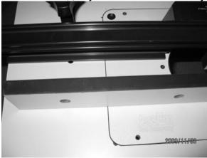
Совместите отверстия на упоре и отверстия накладок. Вставьте в отверстия винты 6Х45 мм (см. фотографию ниже), и ...
