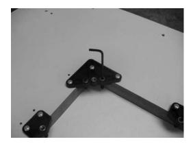
После настройки уровня фрезерной плиты штифтами, её надо притянуть двумя винтами М6Х35мм, через отверстия в углах плиты к пластинам на столешнице.
