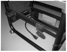
Включатель питания оборудован съёмной клипсой предотвращающей случайный запуск.
