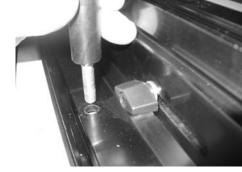
С нижней стороны столешницы винт вкручивается в шестигранную гайку. Гайка перемещается в пазу. (Смотри фотографию ниже)
